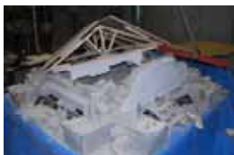
無補強：完全崩壊
