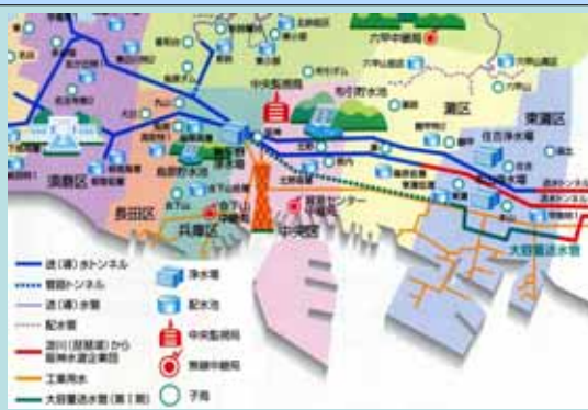
神戸市水道局の上水道システム
